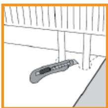
Schneiden Sie das Element entsprechend zu. Bei Heizkörperrohren geben Sie bitte mindestens 5 mm zum Durchmesser des Heizungsrohres dazu. Seien Sie hier besonders vorsichtig, um Beschädigungen am Heizkörperrohr zu vermeiden.
